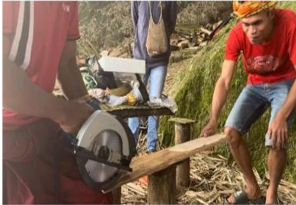
**Gambar 4 Penggunaan Mesin Potong Bambu Modern**
