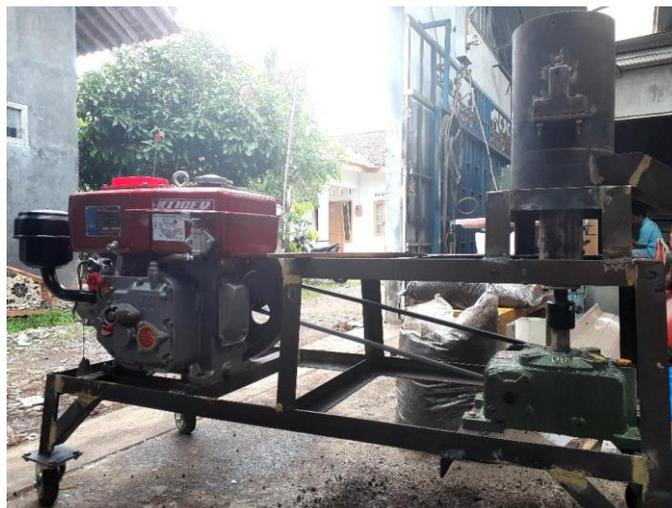
**Gambar 3. Tata Letak Mesin Pelet mulai Mesin Diesel, Gear Box dan Belt Conveyor**
