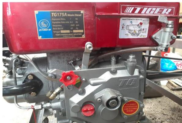
**Gambar 1. Spesifikasi Mesin Diesel dengan Kapasitas 7 HP**
