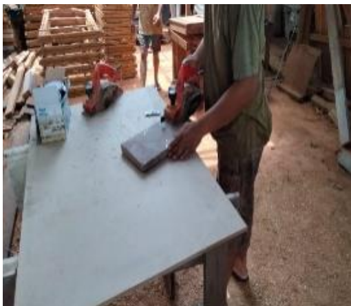
(e) Pengetaman untuk menghaluskan permukaan
